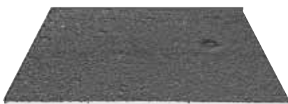
ロールミル処理品 Ra:1.6μm/Rz:25.4μm
