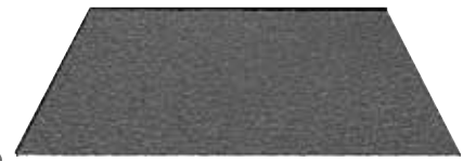
OMEGA 2パス品 Ra:1.0μm/Rz:16.1μm
