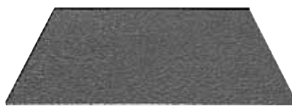
OMEGA 1パス品 Ra:1.5μm/Rz:17.0μm
